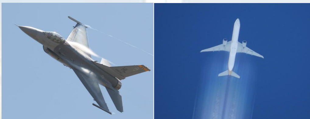
Σχ.1-2 – Contrail wingtrip ή ίχνος συμπύκνωσης ακροπτερυγίου σε μαχητικό αεροσκάφος F-16 αριστερά και σε Airbus A320 δεξιά.
