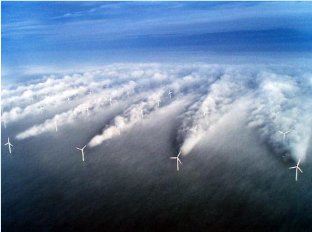
Σχ. 3 - Αιολικό πάρκο στη θάλασσα, 14km δυτικά των ακτών της Δανίας, 12 Φεβρουαρίου 2008, 13:00 τοπική ώρα. Ισχυρός ΒΑ άνεμος σε κορεσμένη από υδρατμούς αέρια μάζα, παρασύρει υδροσταγονίδια της θάλασσας τα οποία περιέχουν κρυστάλλους αλατιού και λειτουργούν ως πυρήνες συμπύκνωσης, ο άνεμος πίσω από τα πτερύγια εξαναγκάζεται να στροβιλιστεί, έχουμε πτώση της πίεσης και αδιαβατική πτώση της θερμοκρασίας και τελικά τη δημιουργία wingtip contrail.
